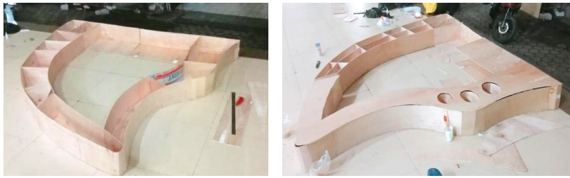
Gambar 11. Perakitan media bentuk harpa
